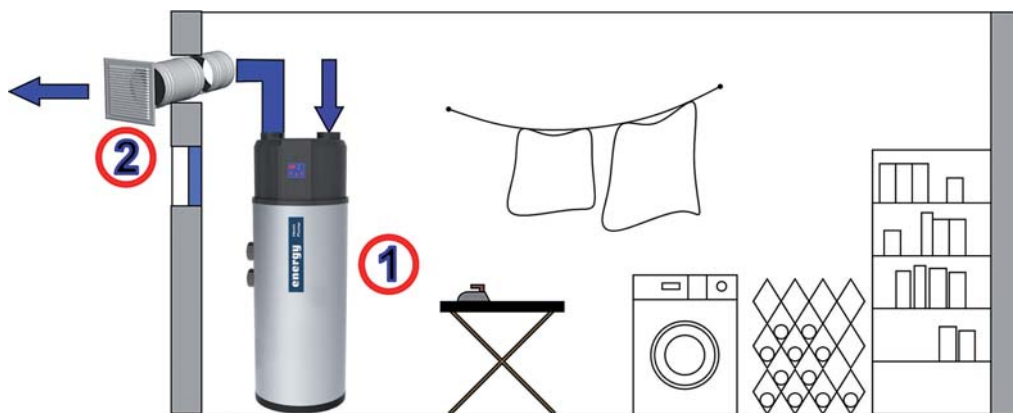
Figura 1 1 Pompa di calore energy energy heat pump Pompe à chaleur energy Wärmepumpe energy 2 Griglia di aspirazione/espulsione GE160 GE160 intake/exhaust grill Grille d'extraction/rejet GE160 Ansaug-/Ausblasgitter GE160
